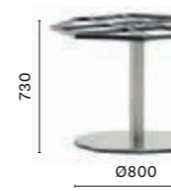
COLUMN Ø 89 TOP MAX HPL Ø1290±Ø 1590 - LAM Ø1300±Ø 1800
